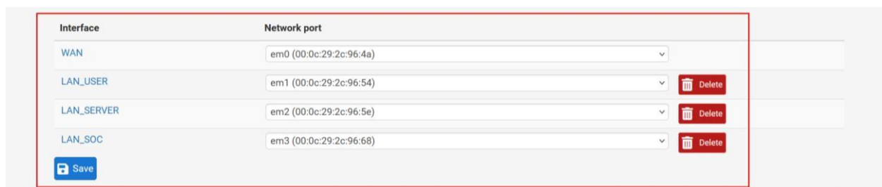
Figure 61 : Vue finale des quatre interfaces réseau assignées (WAN, LAN_USER, LAN_SERVER, LAN_SOC)
